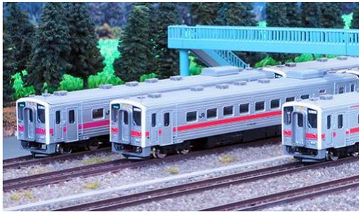
JR北海道で活躍するキハ54形は酷寒地向けとして登場した21m級の両運転台式一般形気動車です。2003年から2005年にかけて機器の更新工事が施工され、外観上では、台車が、従来のDT22からボルスタレス台車N-DT54に交換されているのが大きな特徴です。機器更新工事の他に、鹿笛の設置で、前面のタイフォンが撤去されています。
